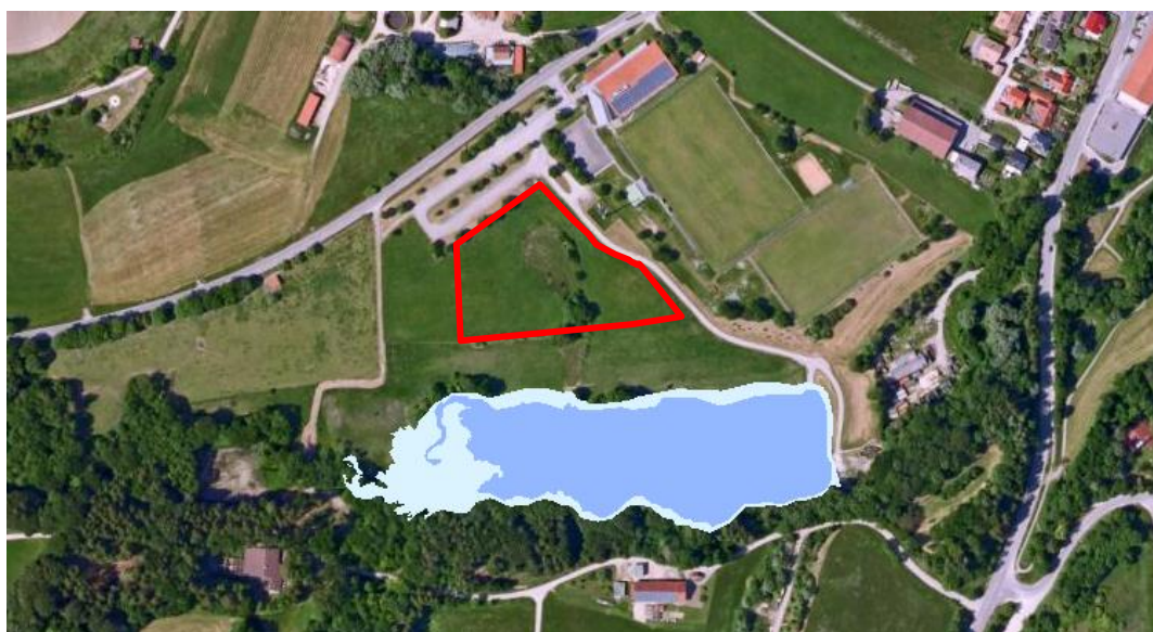
Abb. 2: HQ extrem (hellblau) und, HQ 100 (dunkelblau) Hochwassergefahrenflächen; ohne Maßstab, Stand 28.07.2022, Bayerisches Landesamt für Umwelt, Quelle: © Bayerische Vermessungsverwaltung, Bundesamt für Kartographie und Geodäsie, Bayerisches Landesamt für Umwelt, GeoBasis-DE / BKG, EuroGeographics.
