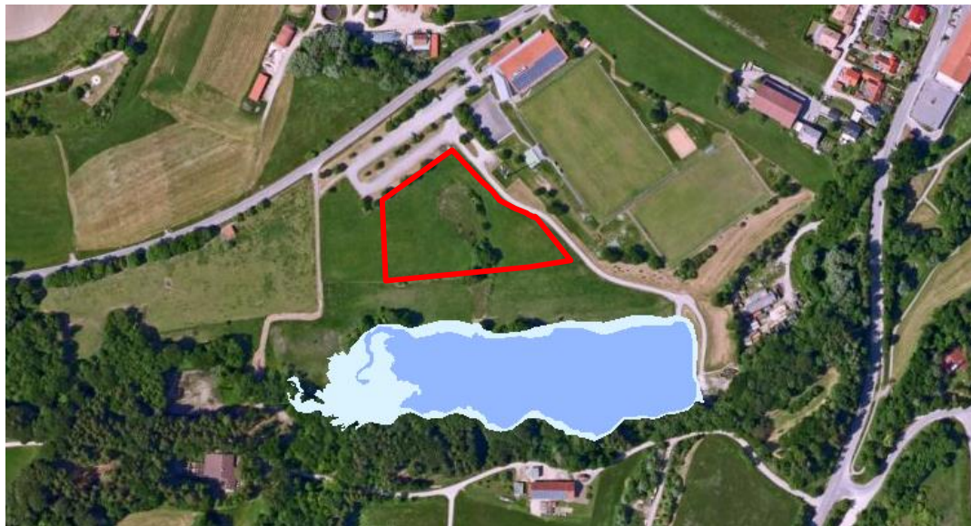
Abb. 3: HQ extrem (hellblau) und, HQ 100 (dunkelblau) Hochwassergefahrenflächen; ohne Maßstab, Stand 05.01.2024, Bayerisches Landesamt für Umwelt, Quelle: © Bayerische Vermessungsverwaltung, Bundesamt für Kartographie und Geodäsie, Bayerisches Landesamt für Umwelt, GeoBasis-DE / BKG, EuroGeographics.
